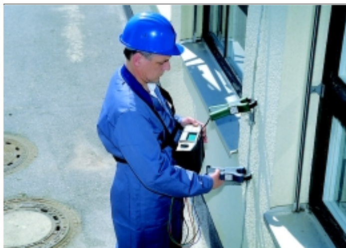
Meranie zemného odporu bez rozpojenia zemníča
