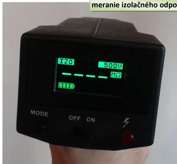
meranie izolačného odporu
