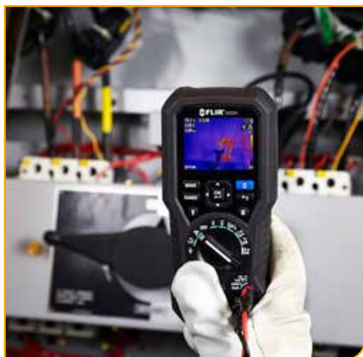
Termografické skenování elektrického rozvaděče
