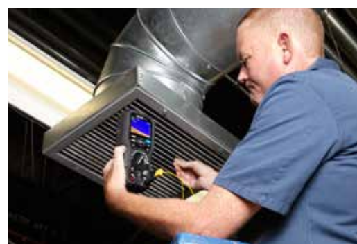
Vstup pro termočlánek typu K pro měření rozdílových teplot
