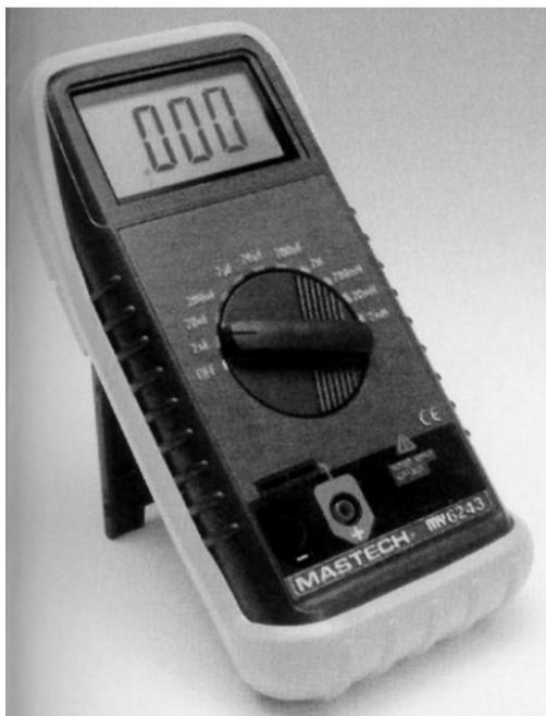
Digitální měřič kapacit a indukčnosti Mastech M 6243A umožňuje měřit indukčnosti na rozsazích 2mH až 2H a kapacity kondenzátorů v šesti rozsazích od 2nF do 200µF. Naměřené hodnoty se zobrazují na 3 1/2 LCD displeji. LC měřič M 6243A je napájen 9V baterií, uplatnění naleze v oblasti servisních měření.
