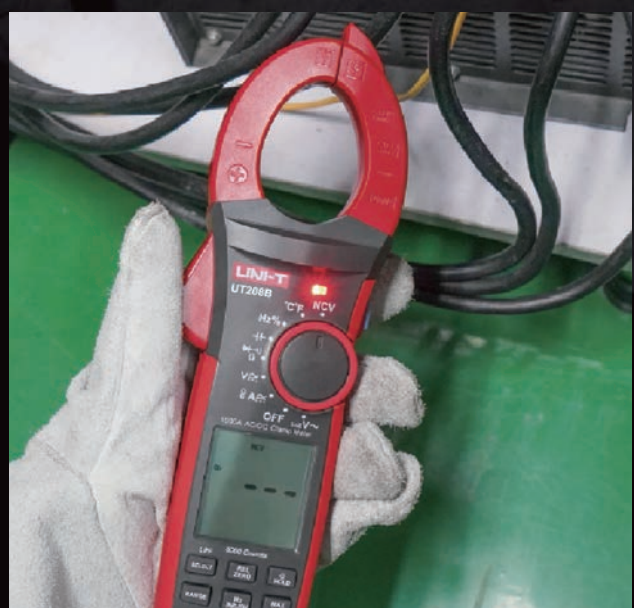
Vícesegmentový displej NCV a zvukový / vizuální alarm
