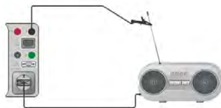
Test izolačného odporu pre spotrebič triedy II.
