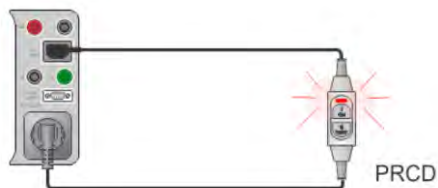
Aktívny test zapojenia
