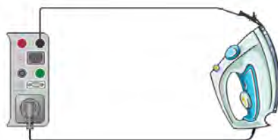
Test ochranného pripojenia
